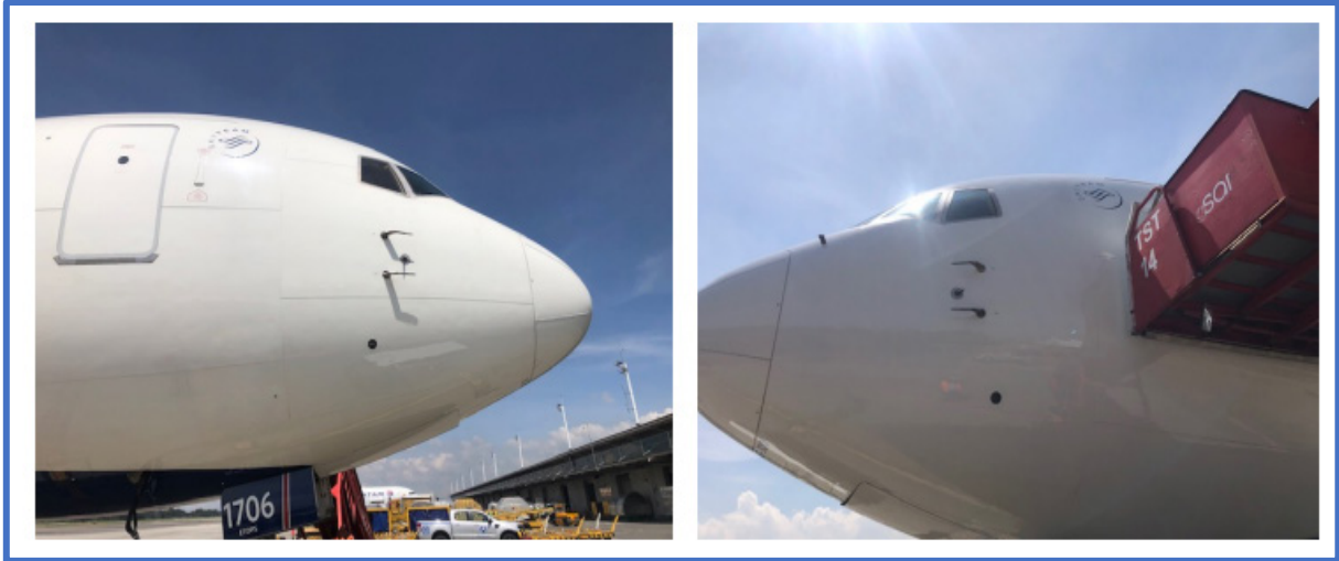
Imagen No. 4: no se observa demarcación zona RVSM.
